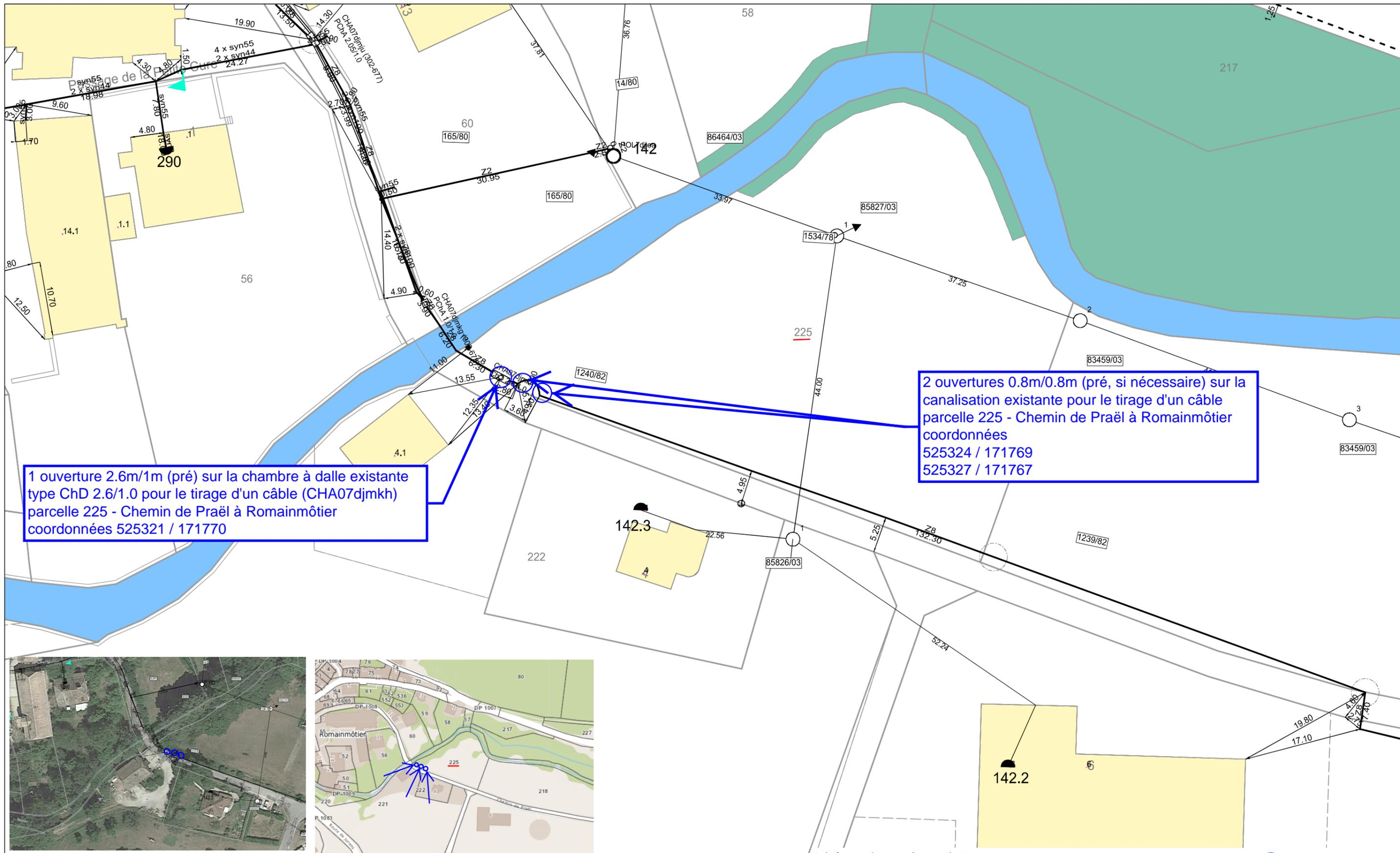
1 ouverture 2.6m/1m (pré) sur la chambre à dalle existante type ChD 2.6/1.0 pour le tirage d'un câble (CHA07djmku) parcelle 225 - Chemin de Praël à Romainmôtier coordonnées 525321 / 171770
